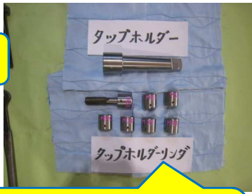
各種のタップにタップホルダリングを製作し、1本のタップホルダーでタップ穴が加工できるようにする。
