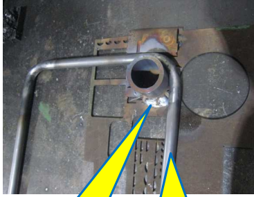
廃材で作したパイプベンダ
